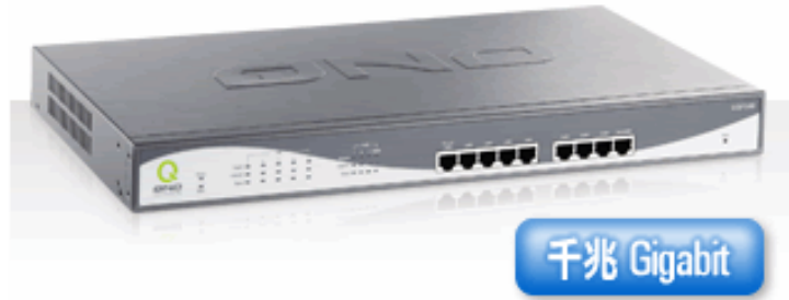
图二：GQF500 产品外观，设计精美，标准机架设计，有 5 个千兆骨干 LAN 连接端口及四个百兆广域网接口，符合商业应用场合使用。
