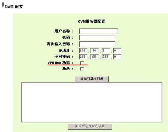
图六：VPN 配置画面的 VPN Hub 功能只能配合 Qno 专有的 SmartLink VPN 使用。
