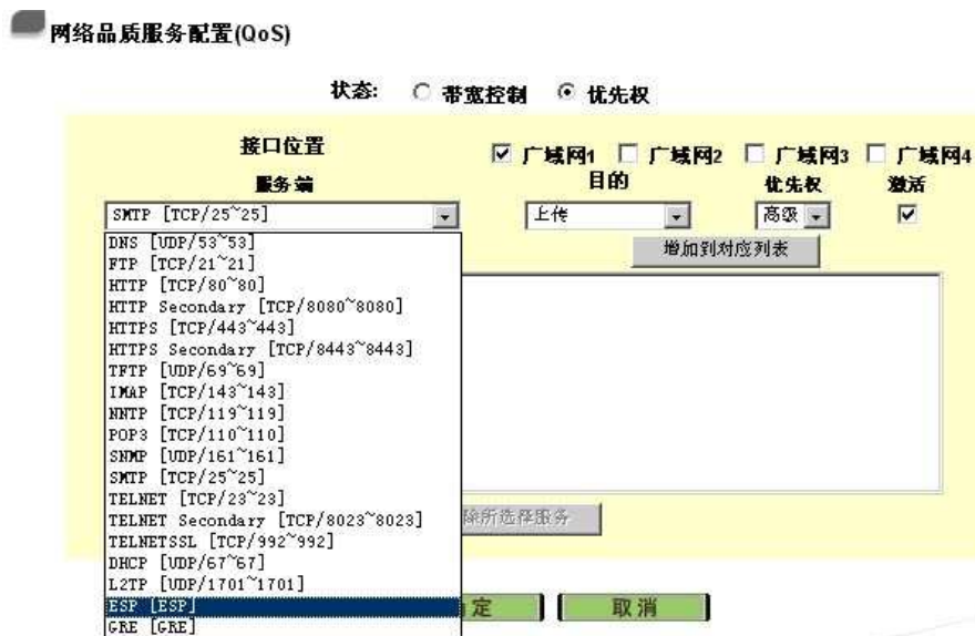
图七：ESP/GRE 封包传输优先级设定
